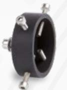
Porte-échantillon cylindrique serrage par vis.
