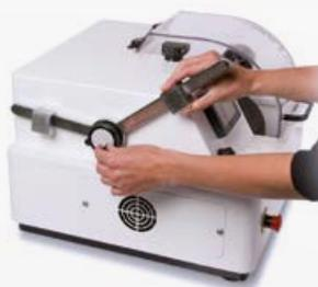
Réglage manuel micrométrique de l'axe Z.
