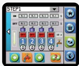
Programmation du doseur DISTRILAM intégrée aux commandes de la machine sur toute la gamme MASTERLAM<sup>®</sup>.
