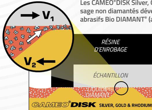
Les CAMEO®DISK Silver, Gold & Rhodium sont des disques de prépolissage non diamantés développés pour être utilisés avec les produits abrasifs Bio DIAMANT® (abrasifs libres).
